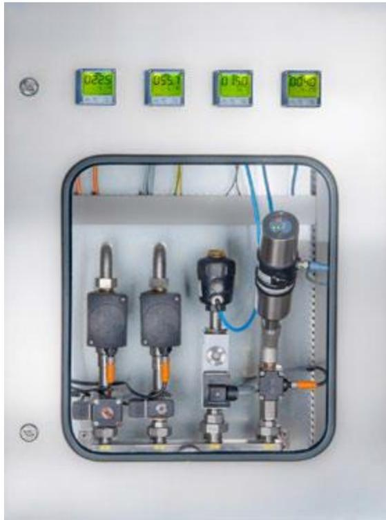
Abb. 4: Kompaktregler in Schaltschrankausführung
