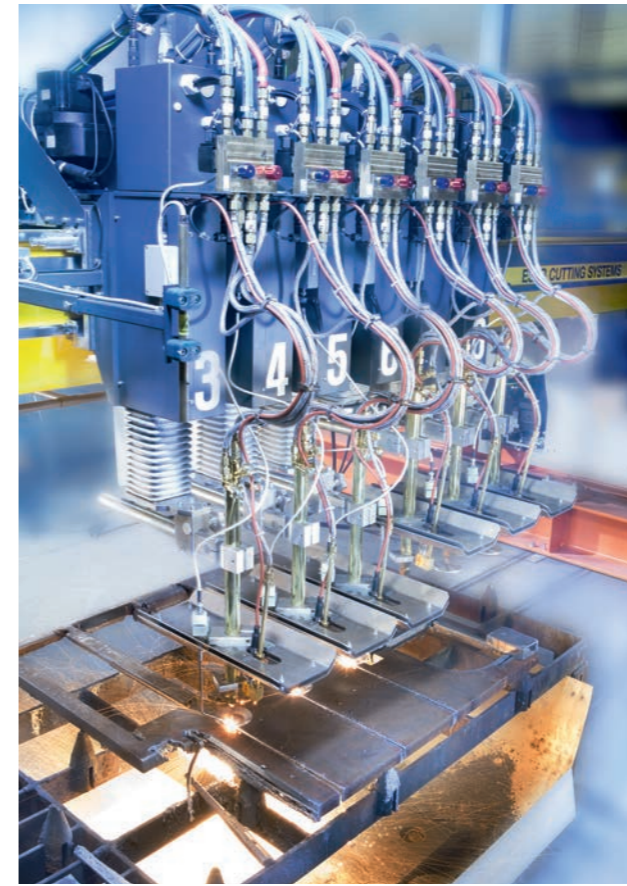
Machine d'oxycoupage au gaz avec une solution système automatisée.
