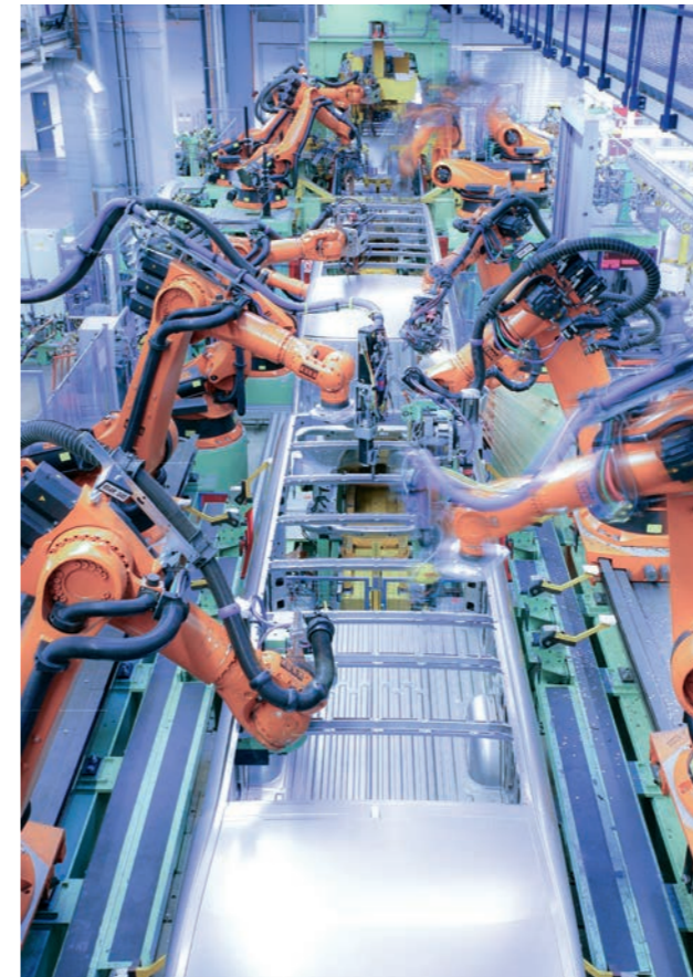
Système de soudage complexe avec module ARC pour le process de soudage MIG.
