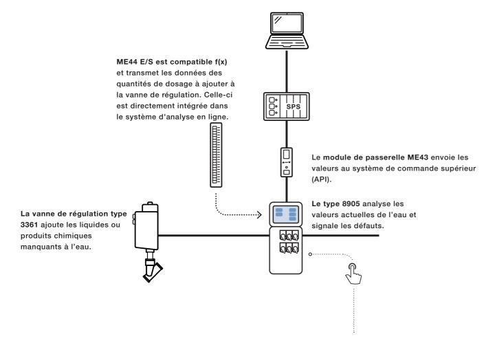
Le logiciel de configuration « Bürkert Communicator » sert au paramétrage et au diagnostic du système d'analyse en ligne. Cela permet une attribution aisée des valeurs cycliques et la représentation graphique de ces dernières. La programmation graphique f(x) offre la possibilité d'adapter les processus localement et individuellement sans avoir à intervenir dans le système de gestion de process.
